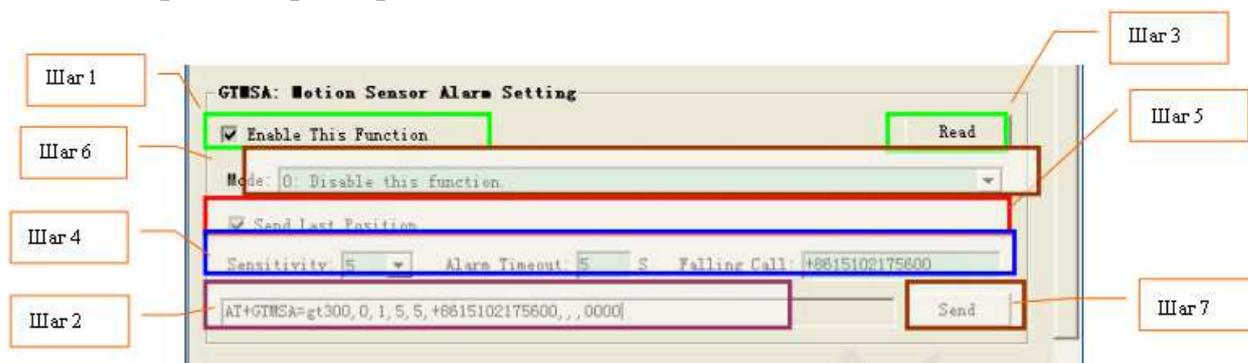
**Шаг 1:** Выберите «Enable this function» («Включить эту функцию»), после этого параметры GTMSA могут быть изменены и кнопка «Send» («Отправить») станет доступной.
