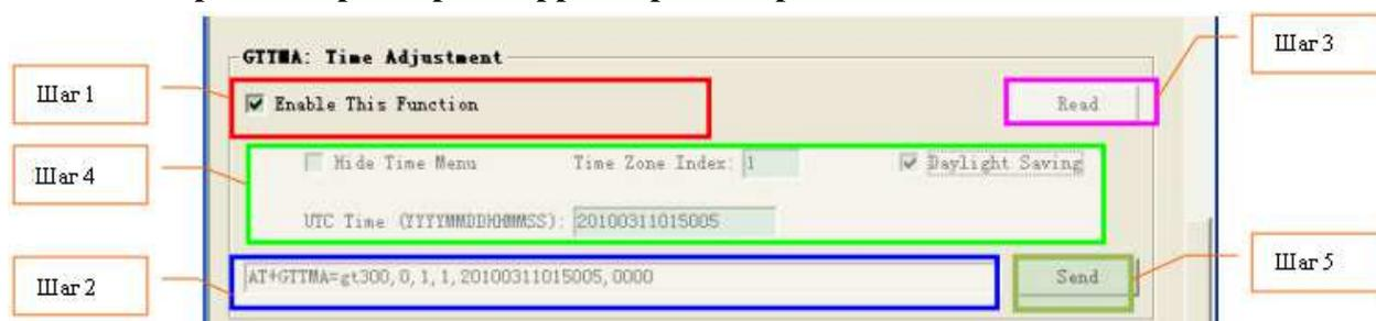
**Шаг 1:** Выберите «Enable this function» («Включить эту функцию»), после этого параметры GTTMA могут быть изменены и кнопка «Send» («Отправить») станет доступной.
